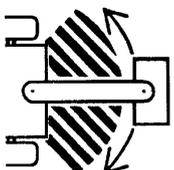
Não transite em rodovias ou estradas pavimentadas. Nas manobras ou curvas fechadas, evite que as rodas do trator toquem o cabeçalho.
